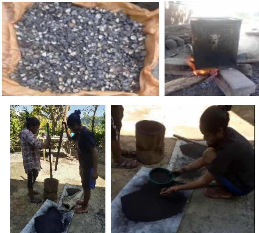
Gambar 2 Bahan dan proses pembuatan arang
