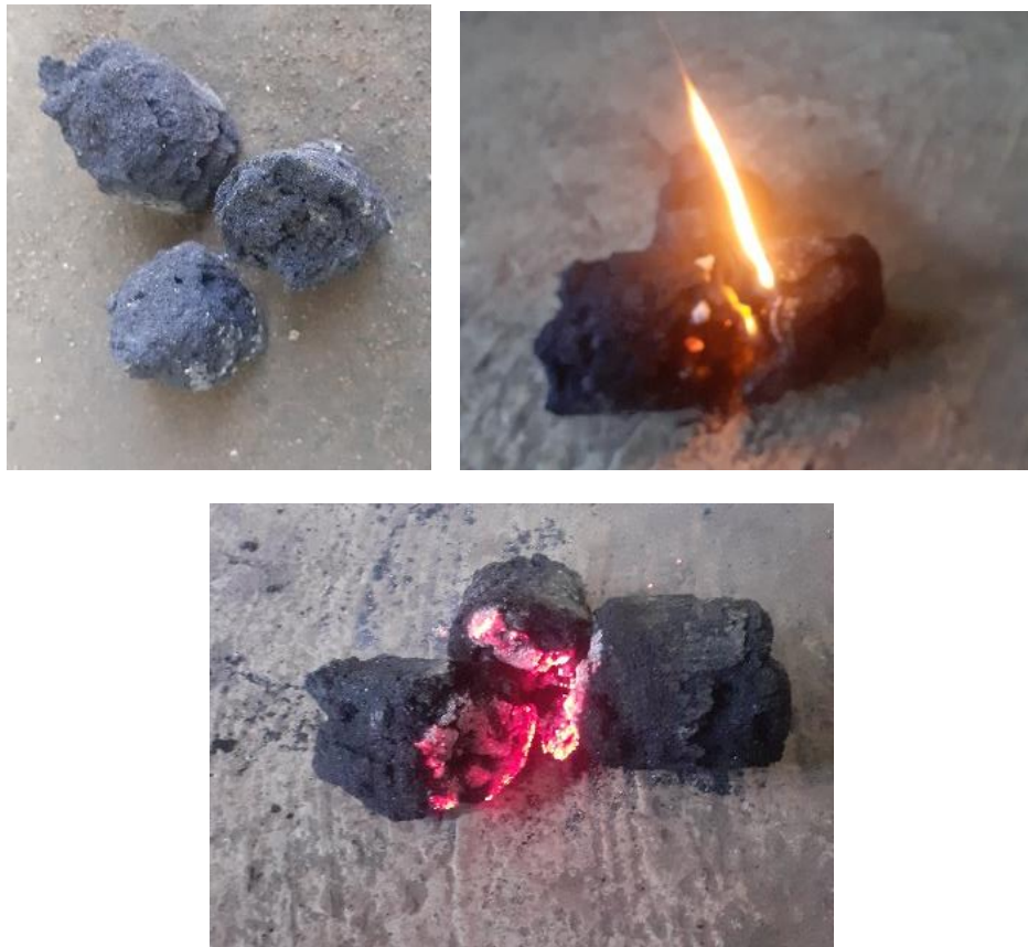
Gambar 4. Hasil pembuatan briket cangkang kemiri
