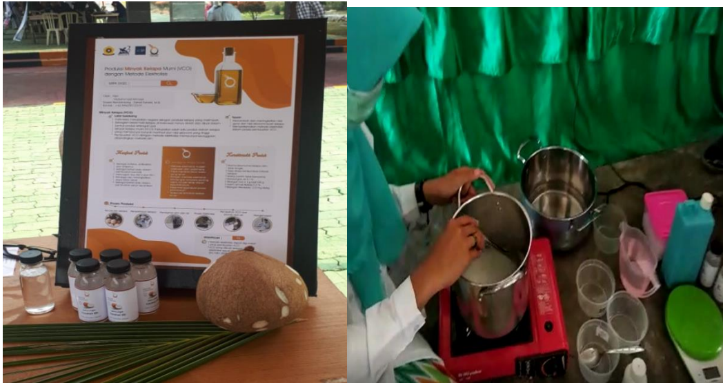
Gambar 4. Mereaksikan VCO dengan soda api untuk menghasilkan sabun
