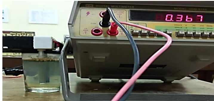
Gambar 6. Tampilan nilai I_{(air-tanah)} pada menit pertama
