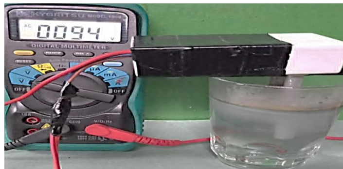
Gambar 5. Tegangan listrik ac output antara elektroda alat elektrolisa
