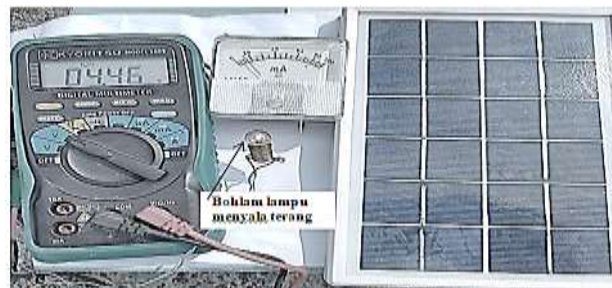
Gambar 5. Tegangan out put mensuplai bohlam lampu kondisi menyala
