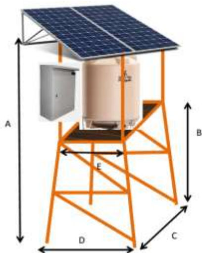
Gambar 4. Rancangan Posisi Panel Surya dan Tandon Air
