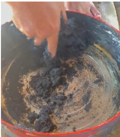
Gambar 5. Pencampuran serbuk arang dengan perekat
