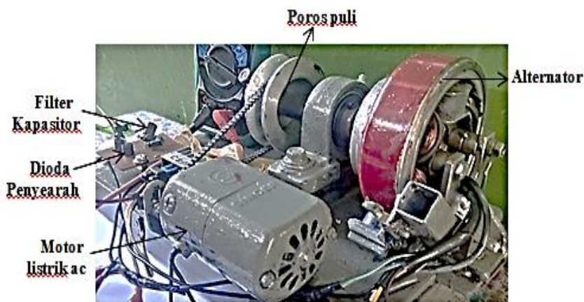
Gambar 14. Keseluruhan rancang bangun pembangkit listrik menggunakan alternator
