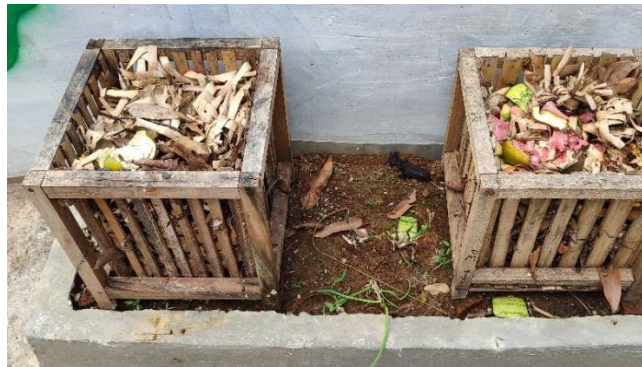
b. Box Bambu untuk proses Bio-Drying
