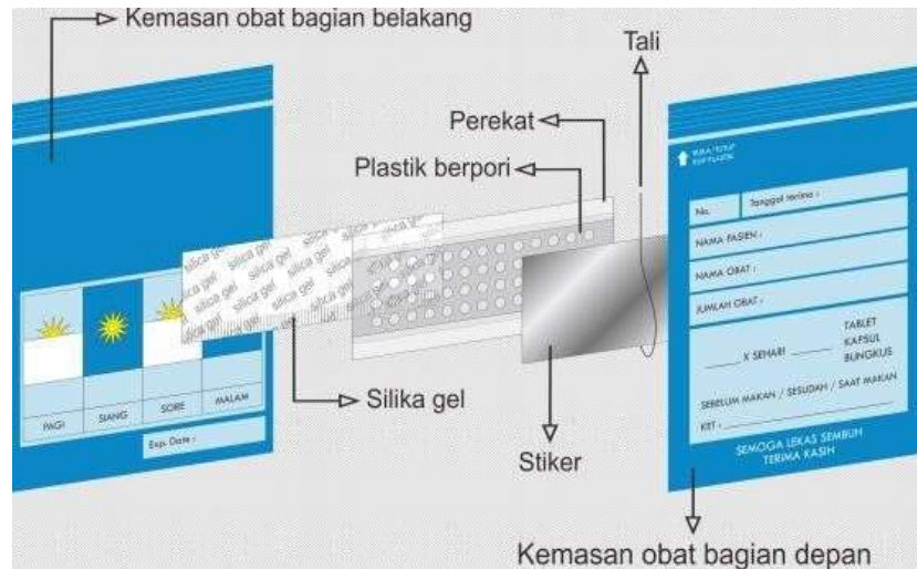
Gambar 3. Desain konstruksi adsorben pada plastik pengemas obat
