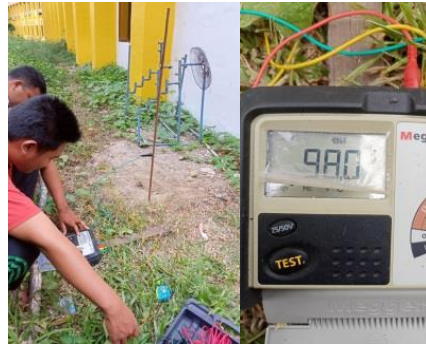
Gambar 4. Proses pengukuran menggunakan Mega Ohm Meter (Megger) Sumber Gambar : Dokumen Pribadi
