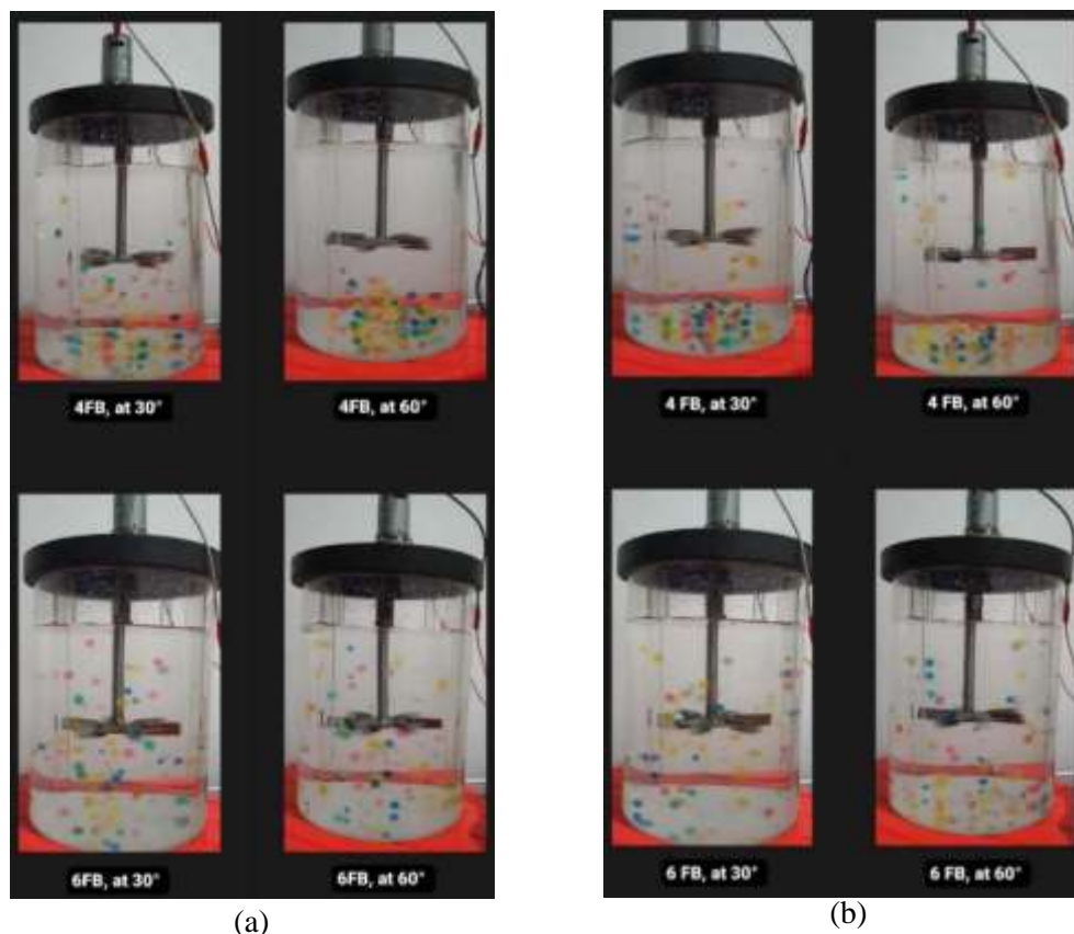
Gambar 2. (a) Pola Aliran pada Detik Ke-5; (b) Pola Aliran pada Detik Ke-10 Sumber: Data Peneliti, 2023
