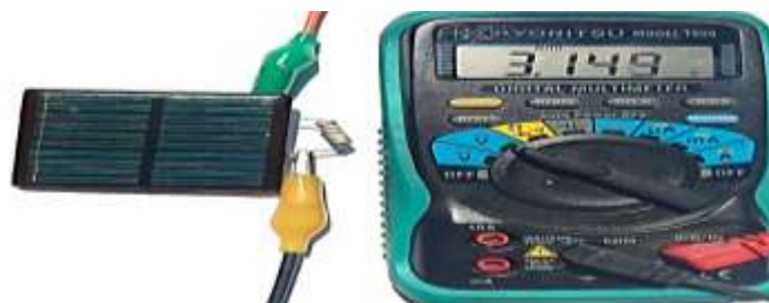
Gambar 9. Hasil tegangan out put sel surya pada tegangan beban resistor V_{b1(R)}
