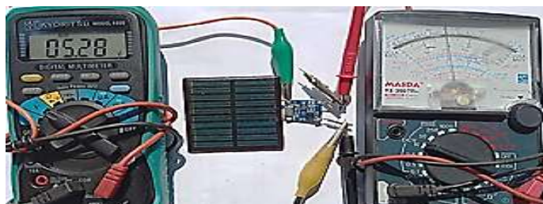
Gambar 12. Hasil tegangan V_{i(konv.)} dan V_{O(konv.)} tanpa beban
