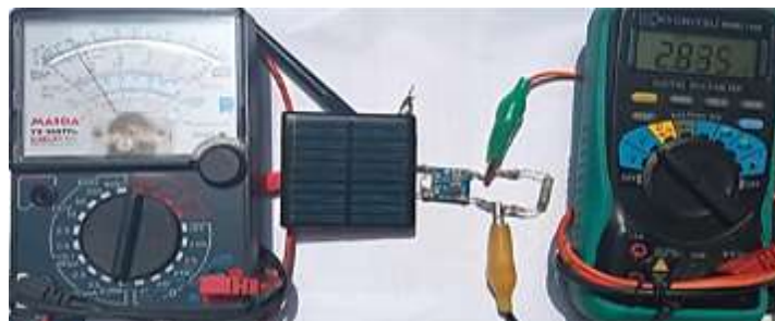
Gambar 15. Hasil pengukuran arus I_{i(konv.)} dan tegangan out put V_{O(konv.)}
