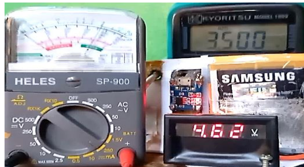
Gambar 5. Hasil V_{i(konv)} = 4,62 volt, V_{o(konv)} = 3,50 volt dan I_{bat} = 0,178 A
