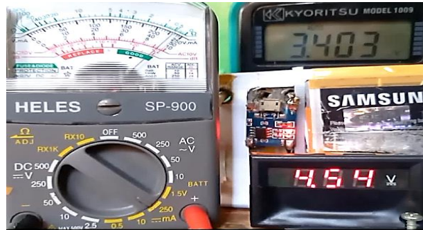
Gambar 4. Hasil pengukuran V_{i(konv)} , V_{o(konv)} dan arus I_{bat}
