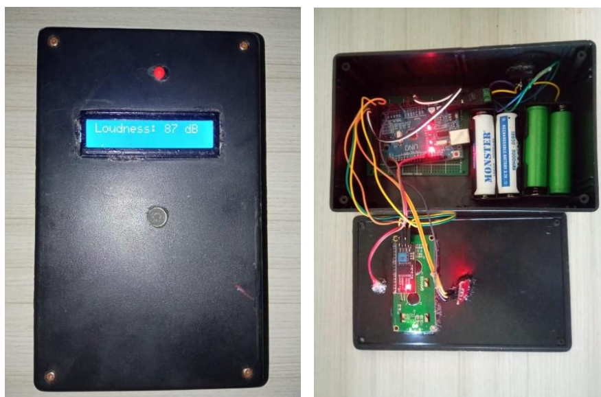
Gambar 4. Alat ukur kebisingan suara yang sudah selesai dibuat, tampak luar (kiri) dan tampak dalam (kanan)
