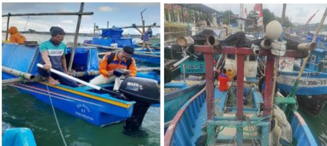
Gambar 6. Pengukuran suara kebisingan mesin kapal pada kapal 3 GT (kiri) dan 11 GT (kanan)
