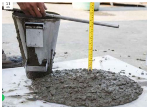
Gambar 2. Cara Mengukur Nilai Slump Sumber gambar: (indoprecast, 2024)
