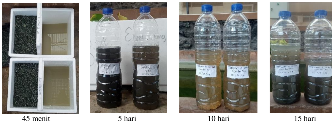
Gambar 6. Masa Pengolahan Kombinasi pada Limbah Cair Kantin Sumber : Hasil Pengamatan, 2024
