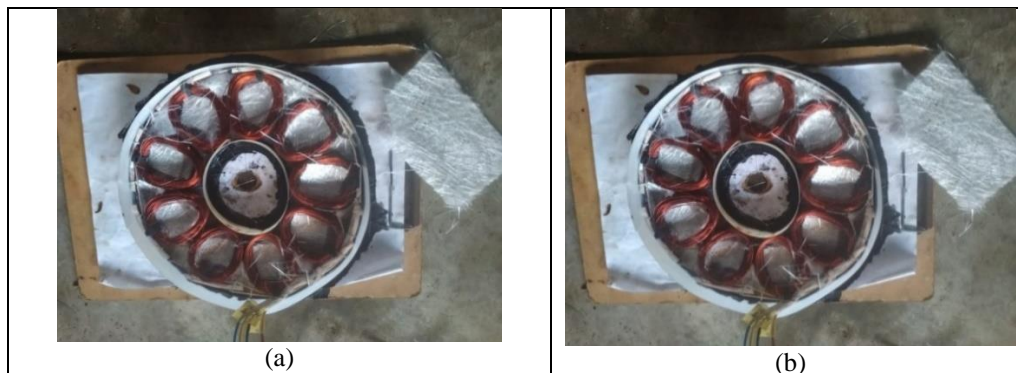
Gambar 7. (a) Rangkaian Stator 3 phase dan (b) Stator yang sudah di Cor Resin
