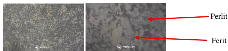
Gambar 5. Struktur mikro pendinginan udara 200x dan 1000x
