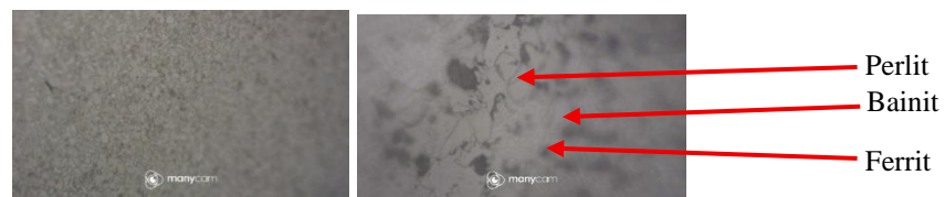
Gambar 6. Struktur mikro pendingin oli 200x dan 1000x
