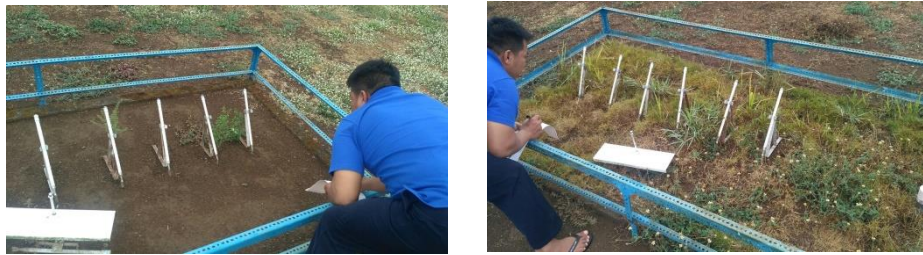
Gambar 1. Proses pengamatan Thermometer Tanah Gundul dan Tanah Berumput milik BMKG Mlati
