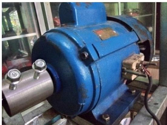
Gambar 2.3 Motor Listrik Pada Mesin Pencacah Plastik.
