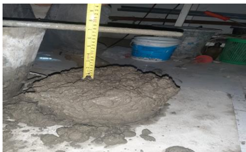
Gambar 6. Slump Test Beton Konvensional (sumber: Data Olahan Penulis, 2024)
