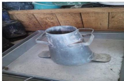
Gambar 5. Kerucut Abram dan Alas uji slump (sumber: Data Olahan Penulis, 2024)
