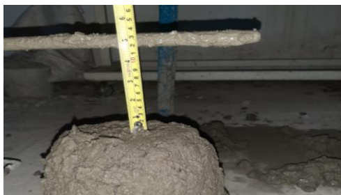
Gambar 7. Slump Test Beton Katalis 5 % (sumber: Data Olahan Penulis, 2024)
