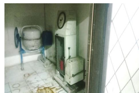
Gambar 3. Molen Mixer dan Alat Test tekan (sumber: Data Olahan Penulis, 2024)
