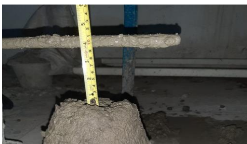
Gambar 8. Slump Test Beton Katalis 10 % (sumber: Data Olahan Penulis, 2024)
