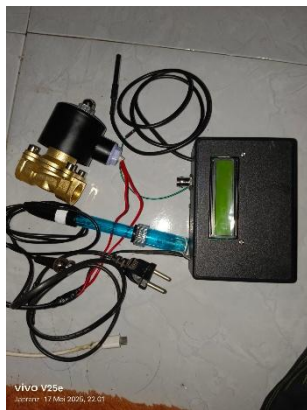
Gambar 3. Rangkaian Sistem Monitoring Suhu dan pH Air Tambak Udang
