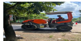
Gambar 3. Tandem Roller (Sumber. Dokumentasi Pribadi)
