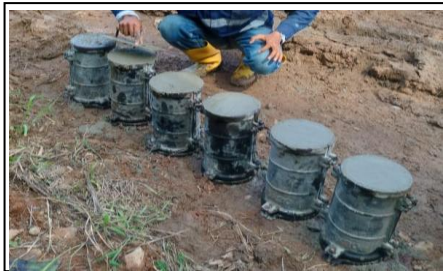
Gambar 5. Pengambilan Sampel Beton
