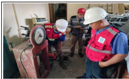
Gambar 6. Uji Kuat Tekan Beton
