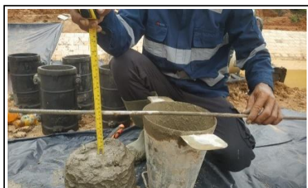
Gambar 7. Pengujian Slump Test Beton
