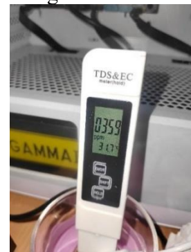
Gambar 8. Pembacaan sensor TDS umum
