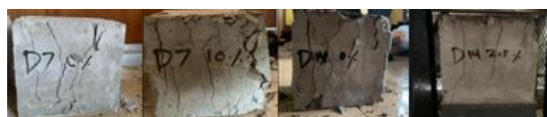
Gambar 3. Pola kerusakan beton setelah uji tekan pada variasi kadar serat ilalang.
