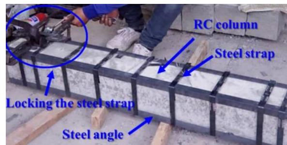
Gambar 2. Benda Uji Eksperimental dengan Perkuatan Baja Siku (Sirimontree et al. , 2021)
